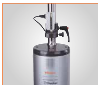
Wzorcowanie długościomierza LG
