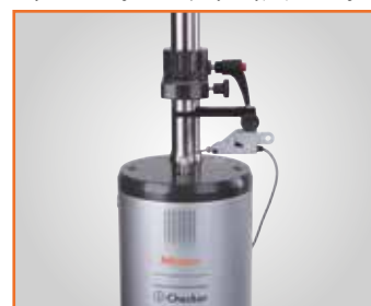
Wzorcowanie czujnika uchylnego indukcyjnego
