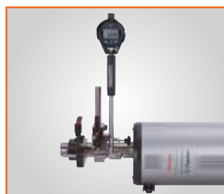
Wzorcowanie przy użyciu dodatkowego uchwytu do średnicówek (typu C)
